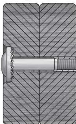
Si vous pouvez voir le filetage et que votre boulon dépasse de l'écrou encastré, il est possible que vous ayez trop serré le boulon ou utilisé du matériel incorrect. Si vous avez trop serré, retirez le boulon et ajoutez des rondelles pour éliminer la saillie.
