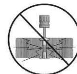
Cette icône vous met en garde contre le serrage excessif de vos boulons. Cela permet d'éviter les dommages structurels ainsi que l'éclatement du bois.
